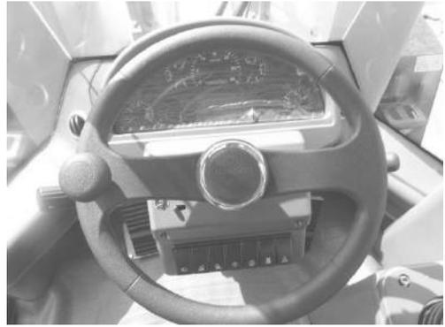
El cargador está equipado con un mecanismo de dirección motorizado de amplificación de flujo coaxial totalmente hidráulico de tipo articulado, y el ángulo de giro del volante no es igual al ángulo de giro del cargador. Cuando el volante se gira continuamente, el ángulo de giro del cargador aumentará hasta que se obtenga el ángulo deseado. La velocidad de giro del cargador aumentará a medida que aumenta la velocidad de giro del volante.
