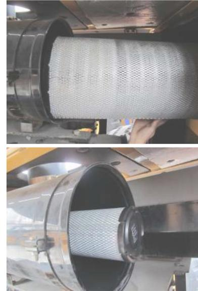
4. Elimine el polvo del papel de filtro del elemento filtrante principal con aire comprimido libre de neblina de aceite, agua (presión inferior a 300 KPa)
