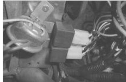
2. Antes de soldar, debe quitar los conectores del mazo de cables del tablero para evitar daños al instrumento.
