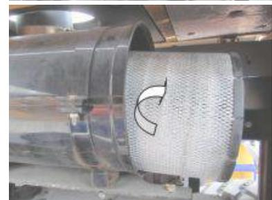
3. Limpiar la pared del revestimiento del filtro de aire.
