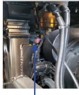
Respiraderos de la caja de transmisión
