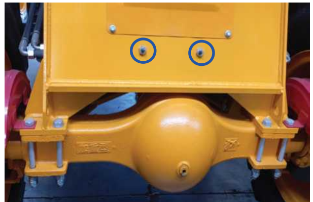
Cojinetes de los cilindros de dirección.
